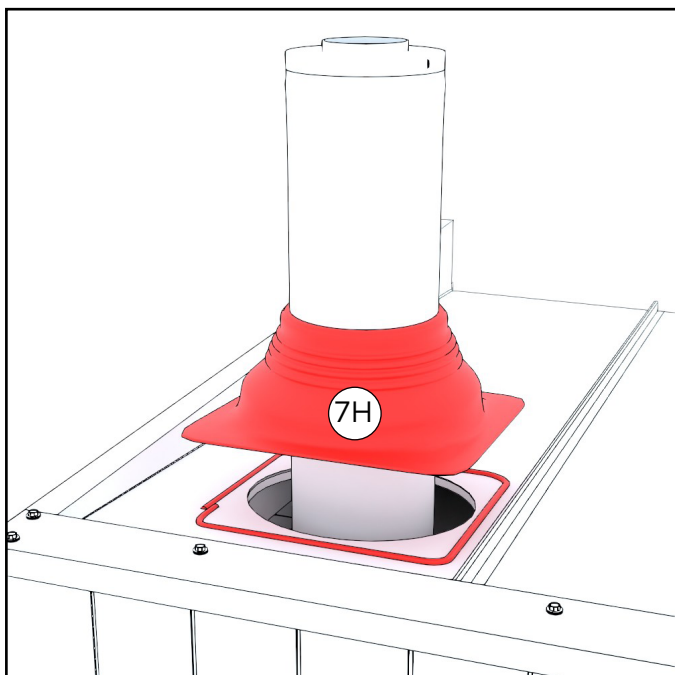
15. Pujota piipun yläkautta sadekaulus ja painele se huolella silikonin päälle kiinni peltikattoon. Ylipursunut silikonin tasoite- taan kauluksen reunaa vasten.
